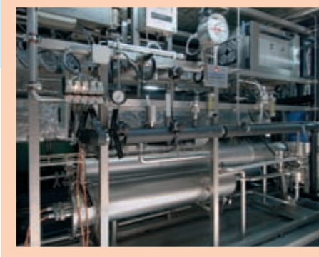
La combinaison des différentes technologies tels que : l'ultrafiltration, l'échange d'ions, l'osmose inverse, le dégazage sur membranes, l'électrodésionisation permet de produire de l'eau ultra purifiée
