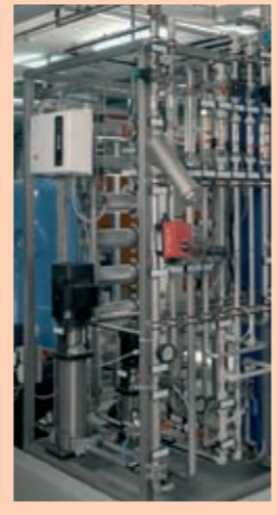
La combinaison des différentes technologies tels que : l'ultrafiltration, l'échange d'ions, l'osmose inverse, le dégazage sur membranes, l'électrodésionisation permet de produire de l'eau ultra purifiée
